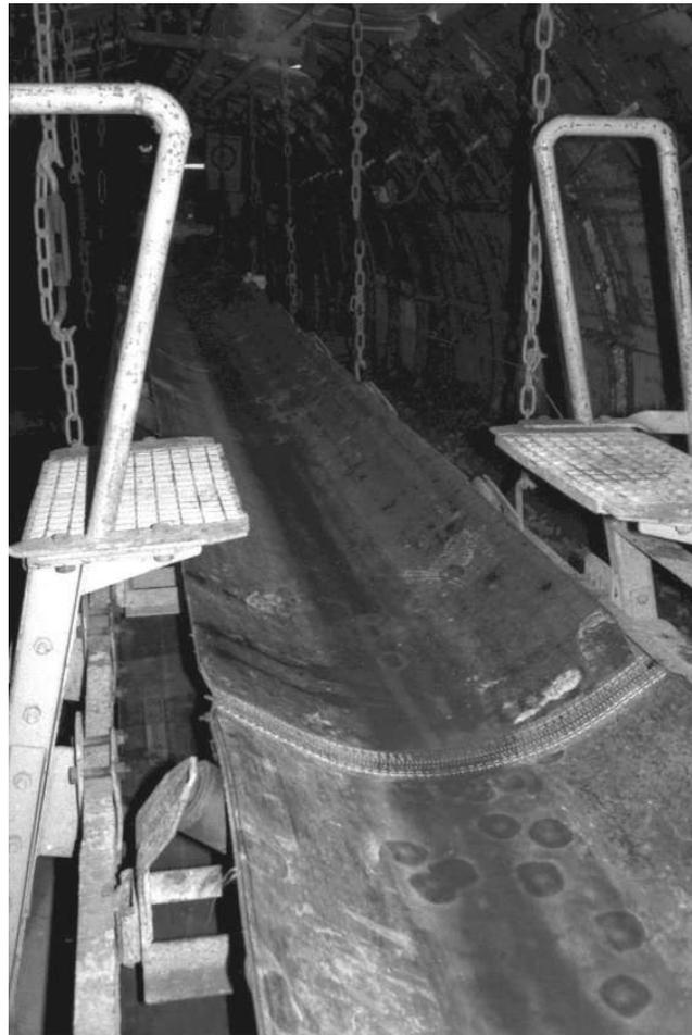
Es müssen Stahlträger aufgehängt und Bohlen aufgelegt werden; die Bühne wird abgespannt und mit Rückenschutz und Leiter versehen. Es handelt sich um einfache Handarbeit, die im Team ausgeführt wird. Sie ist nicht bergbautypisch, muß aber unter Tage sehr häufig ausgeführt werden.
